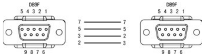
Рисунок В.6 – Кабель KC4 для подключения ПЛК154 к панелям ИП320, СП270 и СП3хх (порт RS-232 Download)
