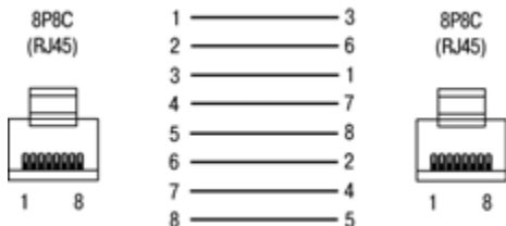
Рисунок В.7 – Кабель Ethernet crossover
