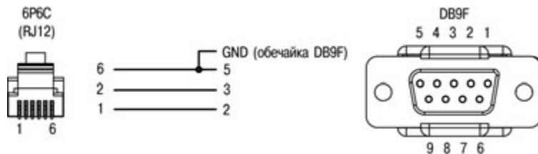
Рисунок Г.2 – Схема кабеля КС2
